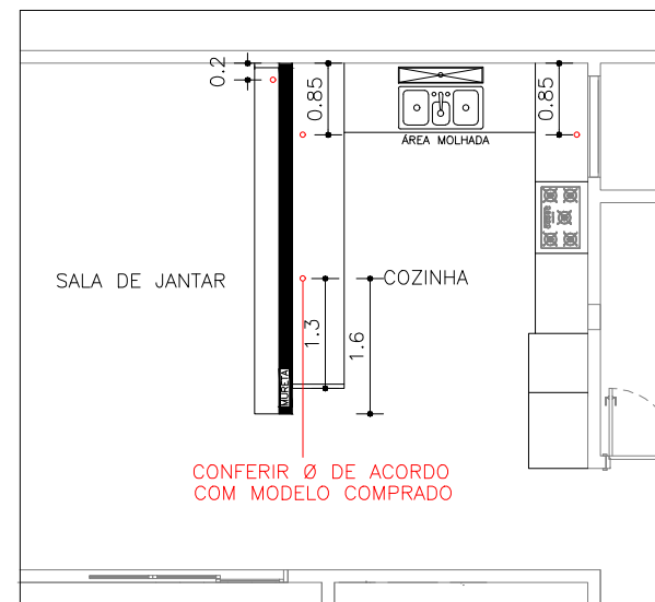
TORRE DE TOMADAS NA BANCADA
