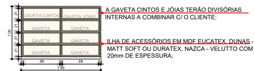
VISTA INTERNA - ILHA - CLOSET MARCENARIA ESCALA 1/50
